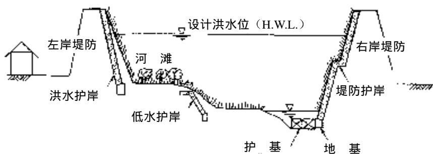
图 1-9 高水护岸和低水护岸
