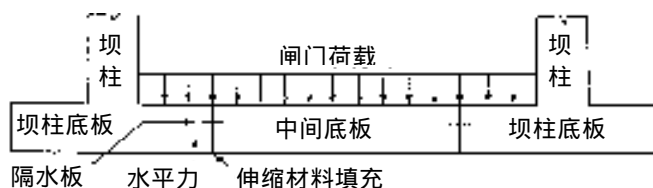
图 1-30 主体形状为倒 T 形时的底板
